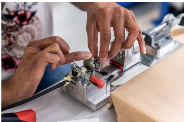
Gefertigt bei Connect Com in Rothenburg: Glasfaserkabel bestückt mit feldtauglichen Q-ODC-Steckern (zwölf Fasern)
