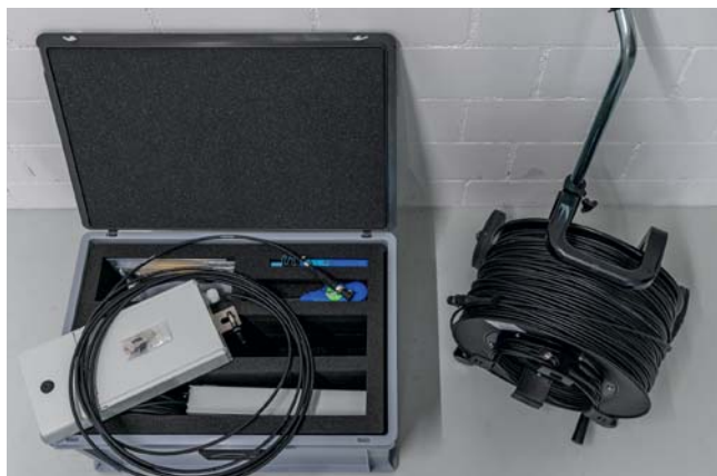
Event-Koffer, der es in sich hat: das mobile Feldkabel bestückt mit feldtauglichen Q-ODC-Steckern (zwölf Fasern), zwei EVI-Boxen als Übergang auf die LCAPC-Steckverbinder und Reinigungsmaterial
