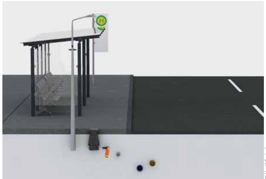
Lichtmast mit Verbindung zur G-Box: Die G-Box kann zur Versorgung öffentlicher Plätze mit WLAN eingesetzt werden. Sie wird über den Lichtmast mit Strom versorgt
