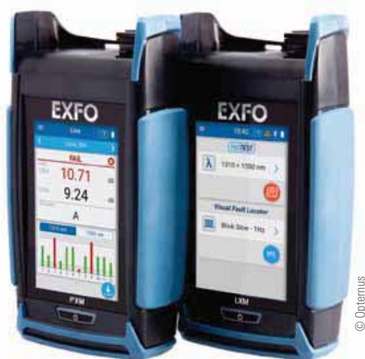
Das neue PXM-LXM MPO-Testset löst das Problem, Verbindungen mit MPO-/MTP-Steckern zu testen
