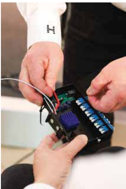
Abbildung 1: Verbinden des InOne Hybridkabels mit dem Hybrid-ODF, der im (zentralen) Verteilerknoten installiert ist
