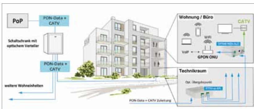
Der optische Wohnungsübergabepunkt OFN46 bietet die Möglichkeit für aktive und passive Teilnehmeranschlüsse und kann flexibel umgerüstet werden
