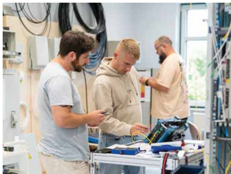
Abbildung 3: Die Teilnehmer trainieren die fachgerechte Durchführung und Dokumentation von Kontroll- und Abnahmemessungen an Glasfasernetzen.
