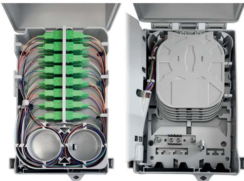
Abbildung 4: WAVEPACE MDU Spleiß-Patch Wandbox. Links: Ansicht bei geöffnetem Deckel, Patchfeld vorkonfektioniert mit 24 SC/APC-Ports und Überlängenaufnahme. Rechts: Ansicht bei aufgestelltem Patchfeld, 6 Spleißkassetten für insgesamt 72 Spleiße, Kabeleinführung und Abfangoption.
