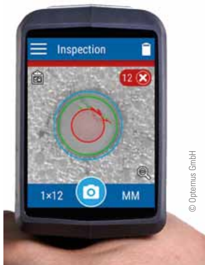
Analyse einer Einzelfaser eines 12-Faser-MPO-Steckers
