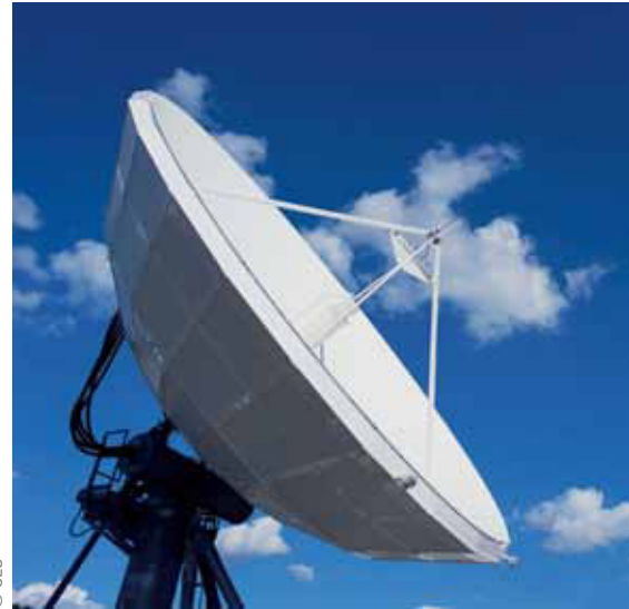
Die aufbereiteten Signale werden über Parabolantennen zum geostationären Satelliten ASTRA gesendet (Uplink)
